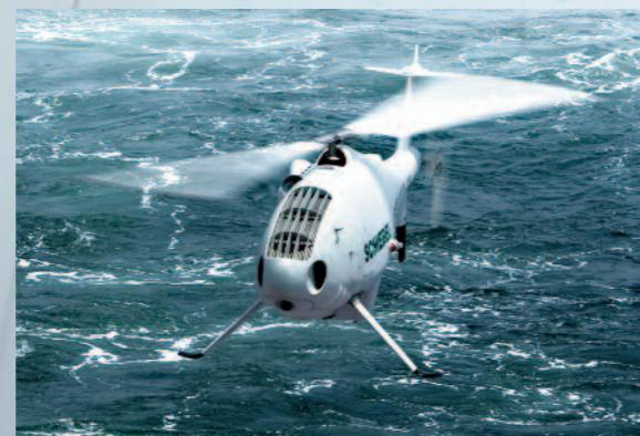
El S-100 está totalmente marinizado contra la corrosión gracias al uso extenso de materiales compuestos de fibra de carbono, acero inoxidable, titanio, anodización y recubrimientos especiales.
