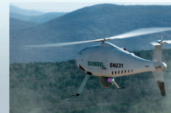
El S-100 se distingue en terrenos complejos donde no existen ni campos de aviación ni pistas de aterrizaje. Además, como sistema VTOL no precisa de ninguna área preparada ni de equipo adicional de lanzamiento o de recuperación.
